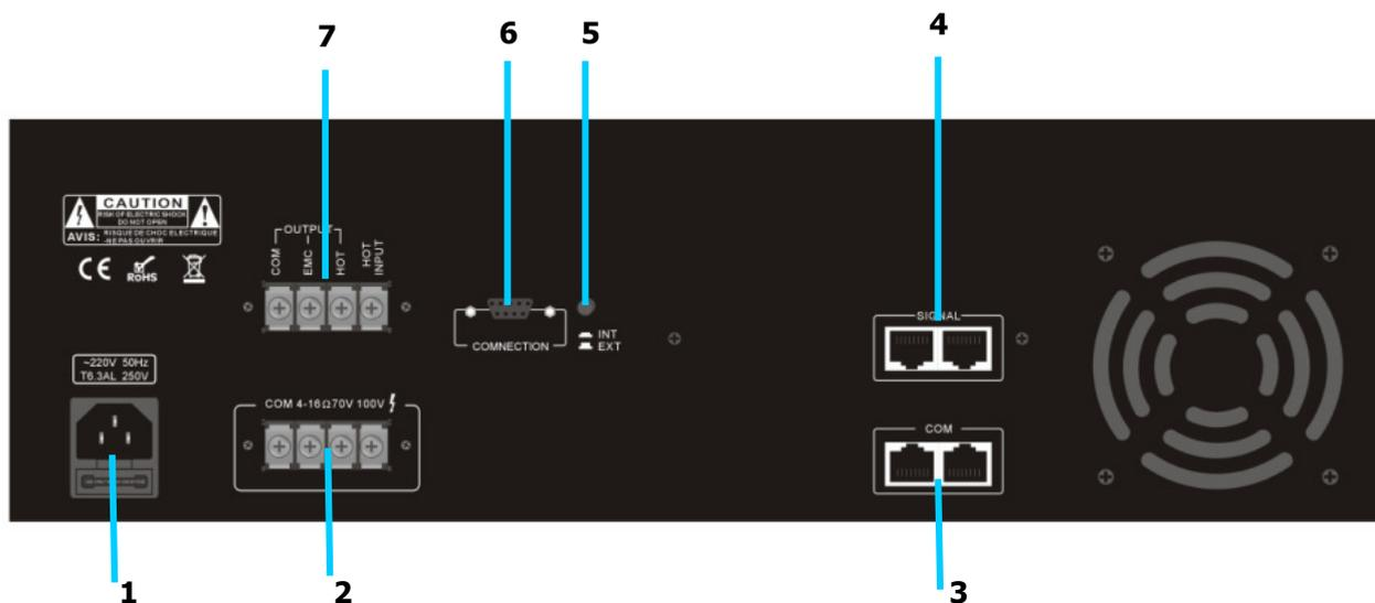
1. **РАЗЪЕМ ПИТАНИЯ AC220V/50HZ** - Разъем для подключения к сети переменного тока.
